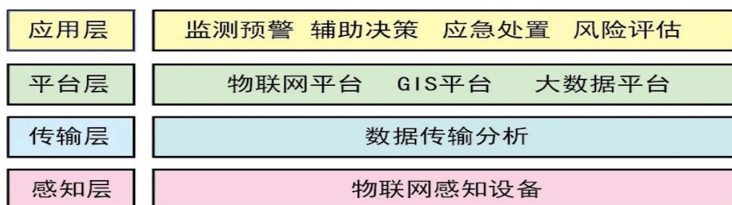
图 5.1.4-1 燃气管网智能安全监测系统架构图
