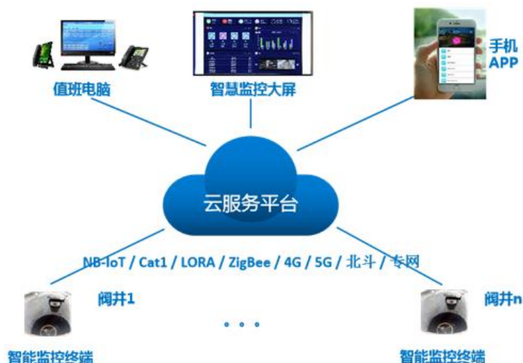
图 5.1.4-2 燃气管网智能安全监测系统示意图
